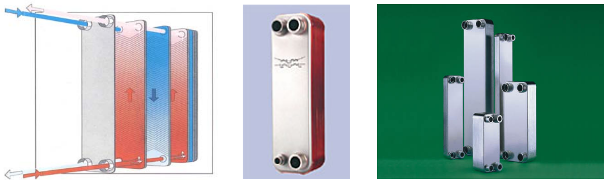
Figur 4.5 Prinsippet for en platevarmeveksler samt eksempler på helloddede enheter (Alfa Laval, 2006).
